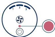
空気清浄機のフィルター交換お知らせランプが赤く点灯したら、メインフィルターを交換してください。使用環境によりますが、6ヶ月毎のフィルター交換を推奨しています。
